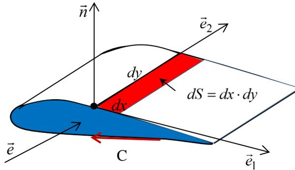
**Fig. 15.** Rotor blade element.
