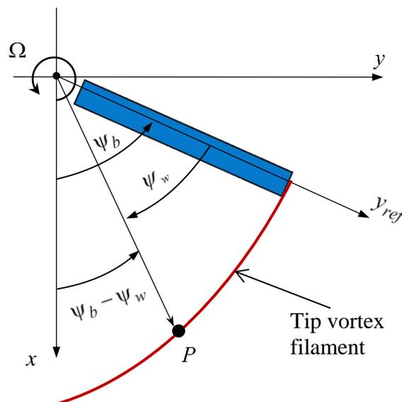
**Fig. 13** Tip vortex trajectory
